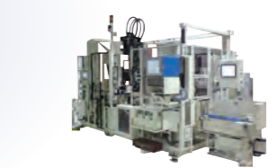
Crank Shaft Automatical Measuring Machines 直列4気筒クランクシャフト計測刻印機
